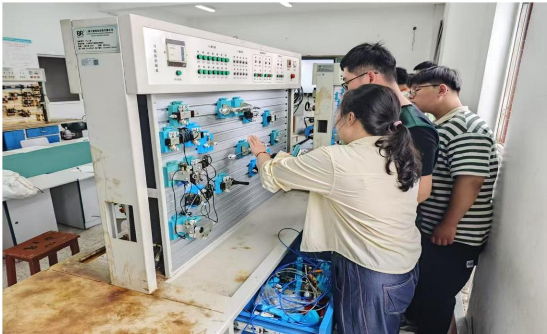
借助 PLC 智能控制系统仿真平台，学生分组完成回路设计与虚拟调试，实时监控压力、流量数据，实现“理论建模-虚拟验证-实物调试”的教学闭环。
